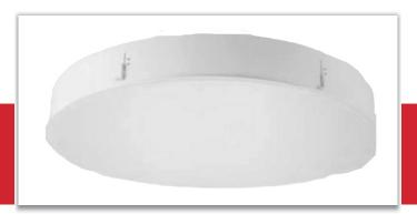
DISK 402 RECESSED è la versione da incasso della famiglia DISK. Fissaggio tramite molle. Corpo in alluminio verniciato e diffusore opale in policarbonato. Diametro 402,4mm. Fascio 120°, finitura bianco. Potenza 30w. Disponibilità di temperatura colore da 3000k oppure 4000k.
